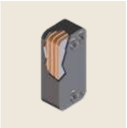
Resistencia eléctrica intercambiador de calor agua Calefacción eléctrica instalada alrededor del intercambiador de calor de placas para proteger el agua interna de las heladas por las bajas temperaturas externas y de las bajas temperaturas del agua. Ref.: CH
